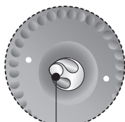
⑤安装密封圈时将分离式内锅盖边缘塞进密封圈背面槽子里,顺着密封圈背面槽子把分离式内锅盖塞进即可安装.
